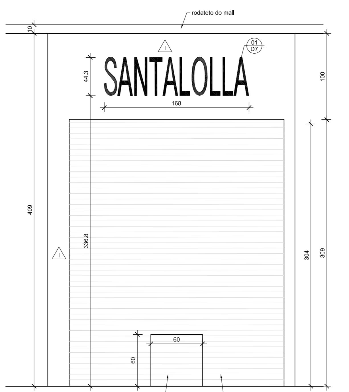
2 Fachada chanfrada ESCALA: 1:25
